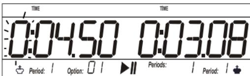
Mit der +- oder der -Taste kann die blinkende Zahl geändert werden. Sobald diese Zahl den gewünschten Wert anzeigt, können Sie mit der ►-Taste die folgende Zahl auswählen. Diese Zahl blinkt dann und kann wieder geändert werden. Fahren Sie mit dieser Vorgehensweise fort, bis sämtliche Zahlen den gewünschten Wert anzeigen. Sobald die Ziffer ganz rechts geändert wurde, kann die Anzahl der Züge angepasst werden. Das Display sieht dann ungefähr so aus:
