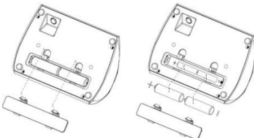
Entfernen Sie den Deckel des Batteriefachs und nehmen Sie die Batterien heraus.
