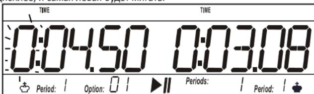
Кнопкой “плюс” или “минус” можно изменить мигающую цифру. Когда на дисплее появилась нужная цифра, при помощи кнопки можно выбрать следующую цифру для корректировки. Эта цифра тоже начнёт мигать, и её также можно изменить. Этот процесс можно продолжать до тех пор, пока все цифры займут нужное положение. После того, как крайняя правая цифра прокорректирована, можно прокорректировать также количество сделанных ходов. После всего этого дисплей может выглядеть примерно таким образом:
