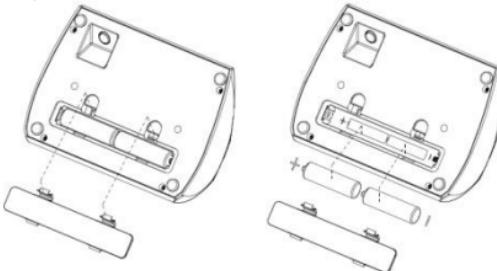
Verwijder het batterijdeksel en verwijder de batterijen.
