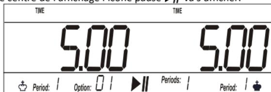
La position du levier détermine de quel côté de la pendule commerce le compte à rebours. La pendule démarre du côté où le levier est le plus élevé. Ceci est indiqué par l'icône blanc ☂ en-dessous de l'affichage. De l'autre côté l'icône noir s'affiche.
