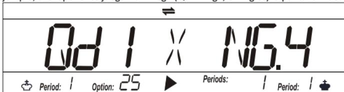
Cuando hay conexión con un ordenador se muestra el símbolo ⇛ en la parte superior de la pantalla.
