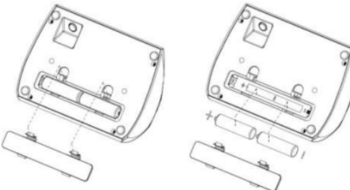
Retire la tapa del compartimento de las pilas.
