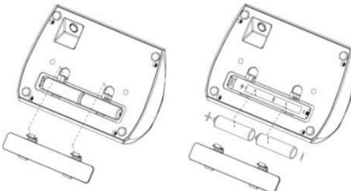
Снимите крышечку и выньте батарейки.
