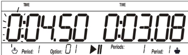
El valor del dígito que parpadea se puede modificar con los botones +o -. Cuando alcance el valor deseado, seleccione el siguiente dígito con el botón ►. Este dígito comenzará a parpadear y entonces podrá ser modificado. Continúe con el mismo procedimiento hasta que todos los dígitos estén correctamente ajustados. Una vez que confirme el último dígito (el décimo a la derecha) la pantalla cambiará y mostrará el número de jugadas.
