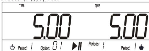
Zu diesem Zeitpunkt muss mit Hilfe des Hebels entschieden werden, die Zeit welches Spielers zuerst zu laufen beginnt. Diejenige Seite des Hebels, welche hochgestellt wird, läuft als erste. Dies wird angezeigt mittels des ♚-Symbols auf der betreffenden Seite. An der Stelle, wo der Hebel nach unten zeigt, wird das ♚-Symbol angezeigt.
